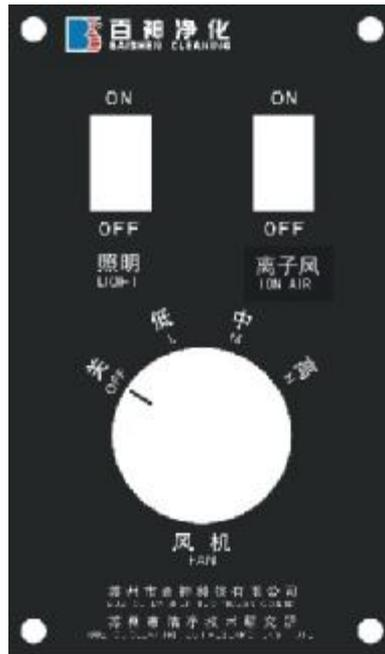
水平流型超净工作台使用前应提前 30 分钟开机自净，工作台台面上，不要摆放不必要的物品，以免干扰工作区内的洁净工作气流，并且净化工作区内尽量避免扰乱洁净气流的流向。
